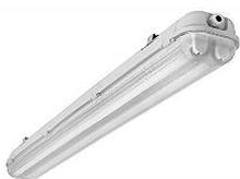
Système d'éclairage suffisamment dimensionné pour garantir 200 LUX à l'intérieur de la pièce (UNI EN12641), y compris une lampe de secours minimum. 25 LUX (UNI EN 1838)
